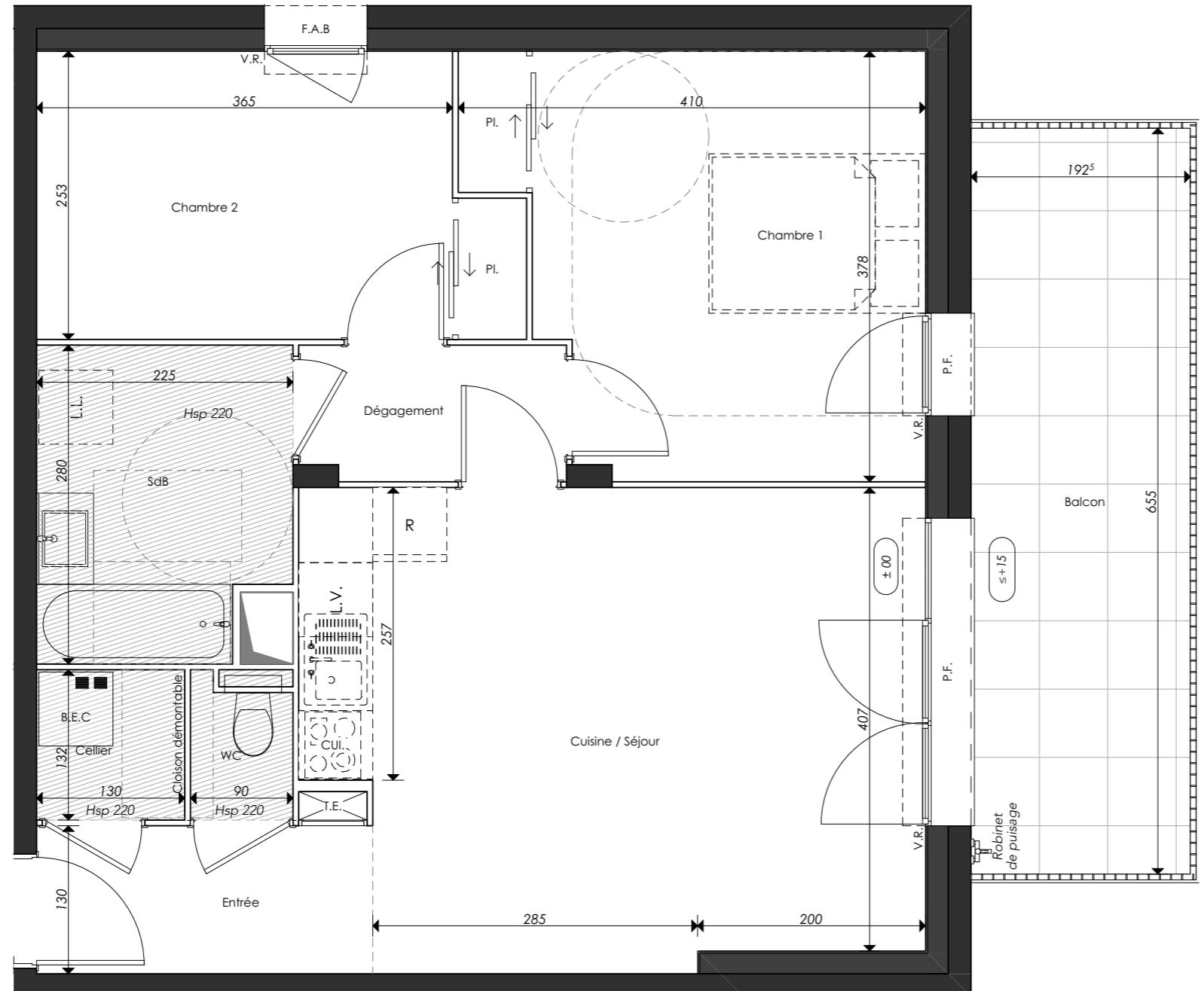
LÉGENDE : P.F. : Porte Fenêtre / F. : Fenêtre / F.A.B. : Fenêtre Allège Basse / V.R. : Volet Roulant / T.E. : Tableau Électrique / Pl. : Placard / CUI. : Cuisson / R. : Réfrigérateur / L.L. : Lave Linge / L.V. : Lave Vaisselle / B.E.C: Ballon Eau Chaude / Soffite, faux plafond / Espace BUREAU / Niveau (+15)
