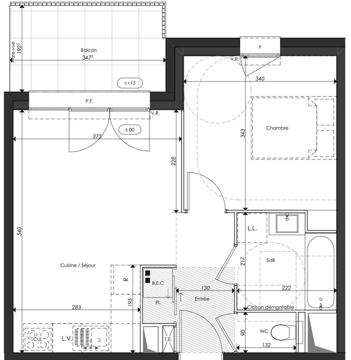
LÉGENDE : P.F. : Porte Fenêtre / F. : Fenêtre / F.A.B. : Fenêtre Allège Basse / V.R. : Volet Roulant / T.E. : Tableau Électrique / Pl. : Placard / CUI. : Cuisson / R. : Réfrigérateur / L.L. : Lave Linge / L.V. : Lave Vaisselle / B.E.C: Ballon Eau Chaude / Soffite, faux plafond / Espace BUREAU / Niveau (+15)
