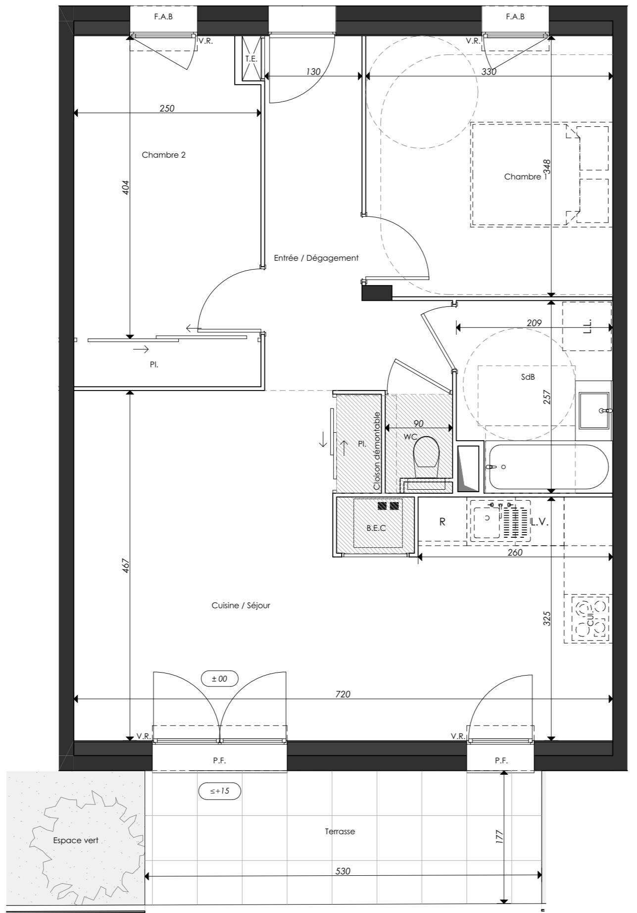
LÉGENDE : P.F. : Porte Fenêtre / F. : Fenêtre / F.A.B. : Fenêtre Allège Basse / V.R. : Volet Roulant / T.E. : Tableau Électrique / Pl. : Placard / CUI. : Cuisson / R. : Réfrigérateur / L.L. : Lave Linge / L.V. : Lave Vaisselle / B.E.C: Ballon Eau Chaude / Soffite, faux plafond / Espace BUREAU / Niveau (+15)
