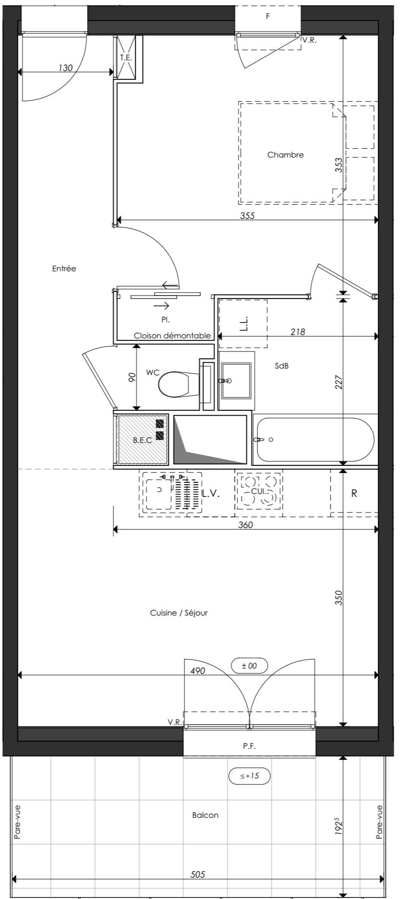
LÉGENDE : P.F. : Porte Fenêtre / F. : Fenêtre / F.A.B. : Fenêtre Allège Basse / V.R. : Volet Roulant / T.E. : Tableau Électrique / Pl. : Placard / CUI. : Cuisson / R. : Réfrigérateur / L.L. : Lave Linge / L.V. : Lave Vaisselle / B.E.C: Ballon Eau Chaude / Soffite, faux plafond / Espace BUREAU / Niveau (+15)
